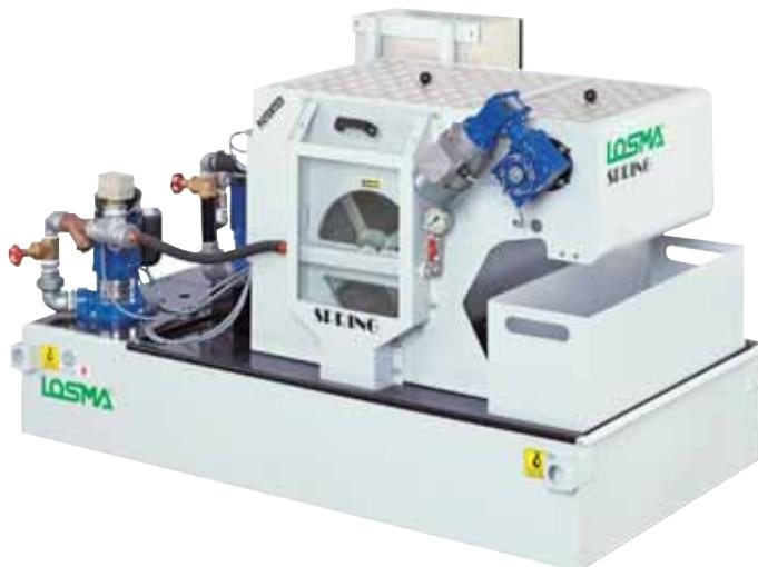
Spring è un filtro a tamburo autopulente, con tela filtrante metallica permanente, per l'eliminazione di particelle magnetiche ed amagnetiche da liquidi refrigeranti interi ed emulsionati.
